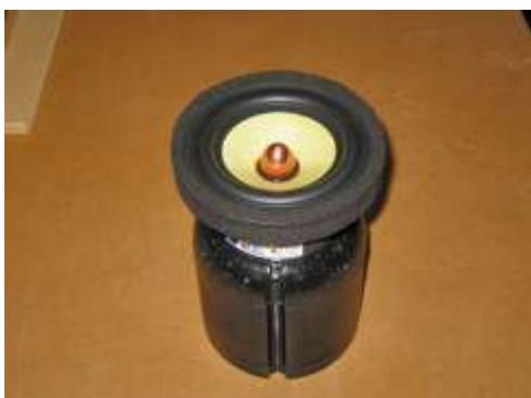
デッドマスの勘合部にエポキシ接着剤をたっぷりと盛りつけて、ユニット磁気回路部を接着します。ユニットを左右交互に回転させながらしっかり押しつけて余計な接着剤や気泡を押し出し、接着面に隙間が残らない様にして下さい。
