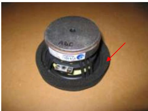
続いて、スピーカーユニットをデッドマスと接着します。（写真↓）事前に接着面に油污や埃が無い様にエタノールやブレーキ洗浄液で清掃して下さい。
